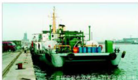
直接安装在双体船上的复合式收油机
