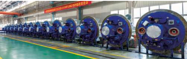
车间装配好的部分舵桨产品 Assembled azimuth thrusters at workshop
